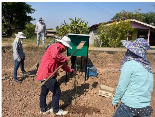
ทดสอบในแปลงทดลองพร้อมติดตั้งเครื่องมือเก็บข้อมูลความชื้นในดิน
