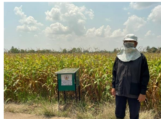
ทดสอบในแปลงทดลองพร้อมติดตั้งเครื่องมือเก็บข้อมูลความชื้นในดิน
